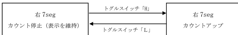
タクトスイッチのクリックによる動作変化の例)
